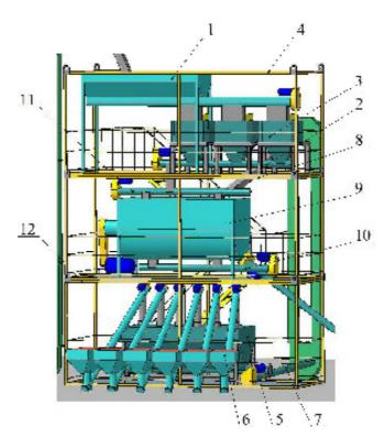
I – накопитель зернофуража; 2 – сборный винтовой конвейер; 3 – молотковая дробилка; 4, 8, 12 – контейнер; 5 – устройство весовое БВМД; 6 – питатель БВМД; 7, 10 – винтовой конвейер; 9 – двухкамерный смеситель;
