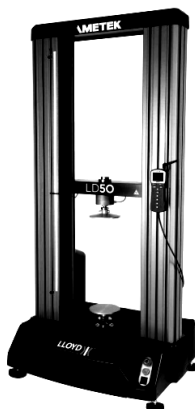
Рис. 10.1. Машина для испытания пластмасс на растяжение (общий вид)
