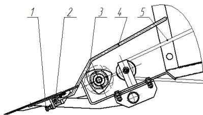
1 – болт регулировочный; 2 – палец; 3 – битер; 4 – пруток интенсификатора;
