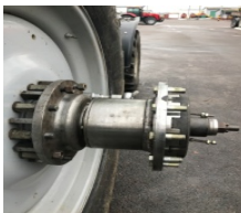
Рисунок 1 – Опорно-сцепное устройство задних сдвоенных колес трактора «БЕЛАРУС» тягового класса 5.0
