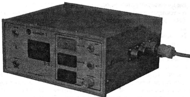
Рис. 3. Анализатор растворов с предварительным заданием предельных значений концентрации и температуры.
