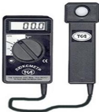
Рис. 1.13. Общий вид люксметра ТКА-ПКМ/31
