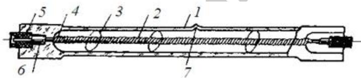
Рис. 2.5. Конструкция трубчатой кварцевой галогенной лампы накаливания:
