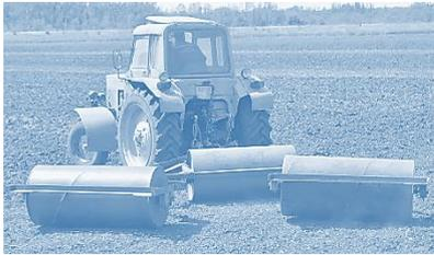
Von Bodenverdichtung wird gesprochen, wenn es durch Aufbringen von Last zu einer Verformung und somit zu einer Veränderung des Drei-Phasen-Systems Boden kommt.
