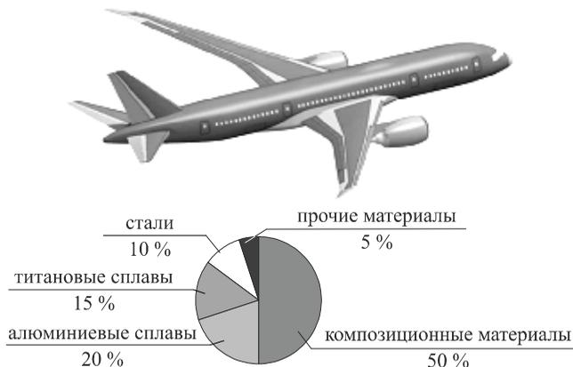
Рис. 38. Структура использованных материалов в Boeing 787 DREAMLINER
