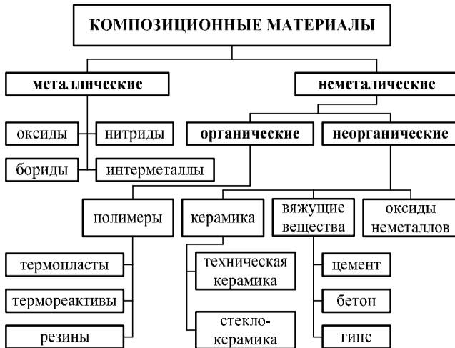
Рис. 39. Классификация композитов по типу матрицы
