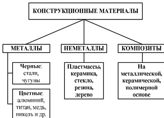
Рис. 6. Условная классификация конструкционных материалов
