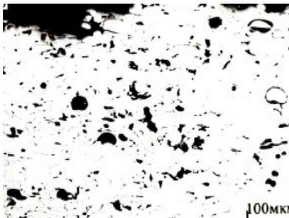
Рис. 16. Фотография газотермического покрытия с порами
