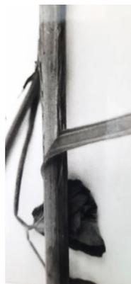
Рисунок 2. Счес покровных тканей со стебля при ударе планкой рабочего органа
