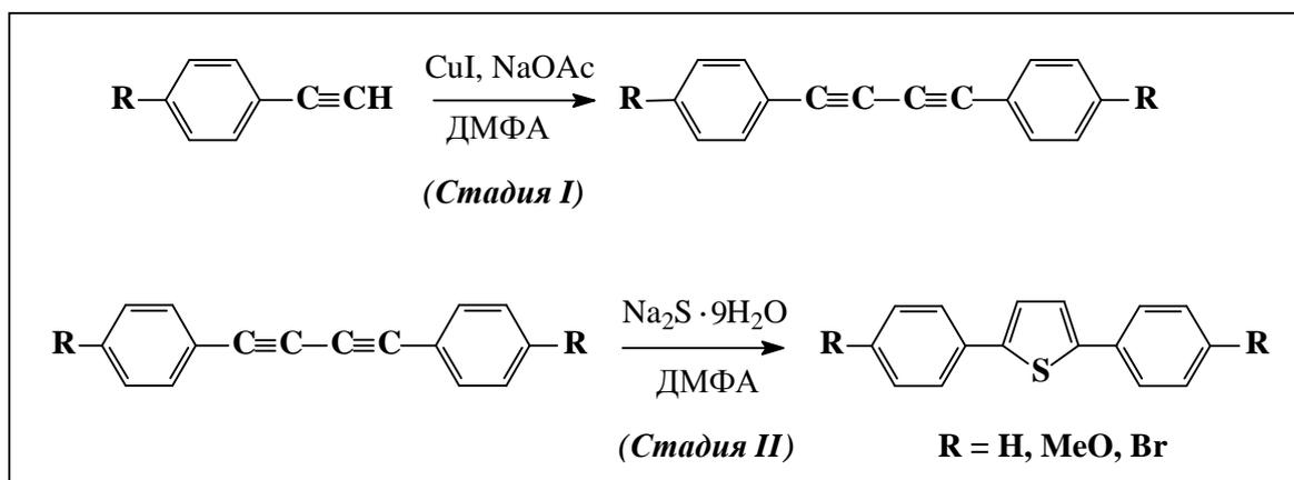
Рисунок 1 – Схема синтеза диметокси- и дибромзамещенного 2,5-дифенилтиофена
