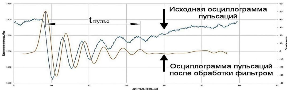
Рисунок 4. Пульсации до и после использования фильтра
