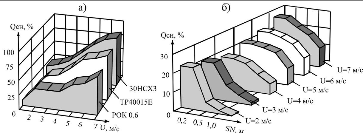
Рисунок 3. – Влияние скорости воздушного потока на количество жидкости снесенной за пределы защитной зоны исследуемыми распылителями  $Q_{сн}$  (%); количество  $Q_{сн}$  (%) и дальность  $SN$  (м) смещения жидкости за пределы защитной зоны распылителем TP40015E
