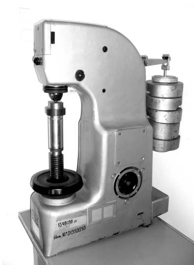
Рис. 1.2. Твердомер ТШ-2 для определения твердости по Бринеллю
