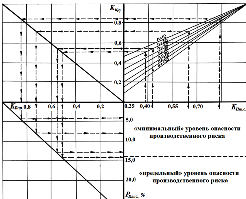
Рис. 2.9. Номограмма для определения уровня опасности производственного риска с учетом интенсивности выполнения технологических регулировок [1]
