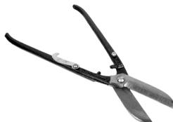
Рис. 1.6. Ручные ножницы по металлу
