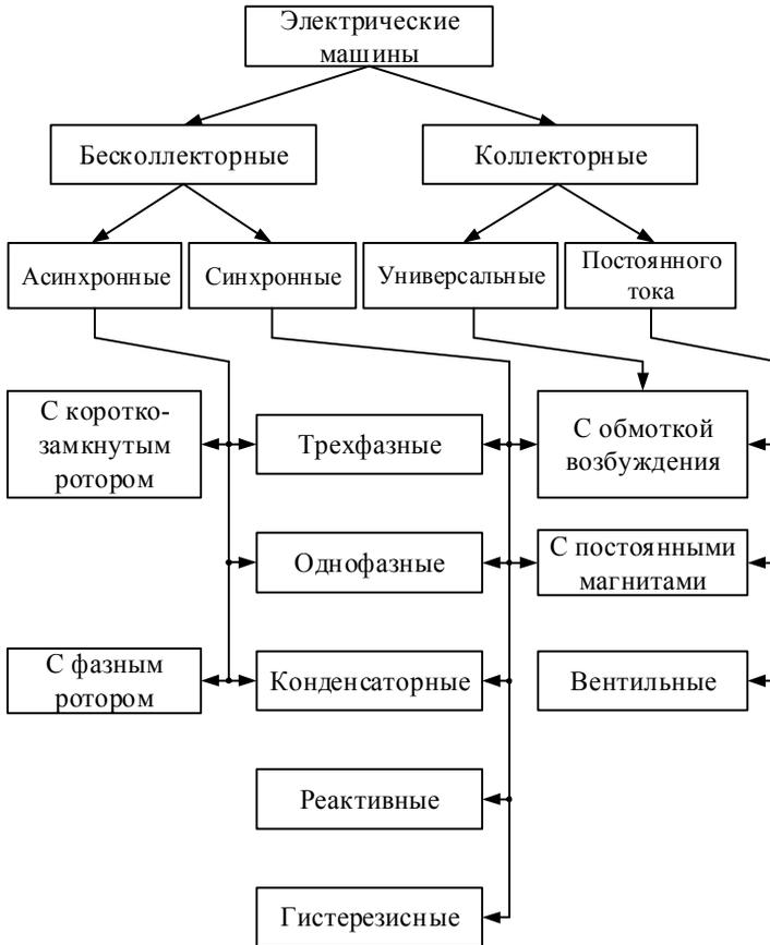
Рис. 3.1. Структура классификации электрических машин
