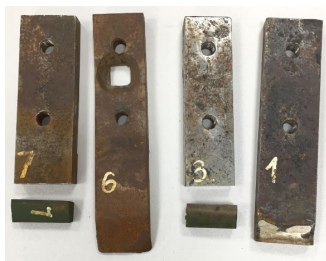
Рисунок 1 – Испытуемые образцы долот для определения микроструктур и микротвердости, упрочненные разным методом
