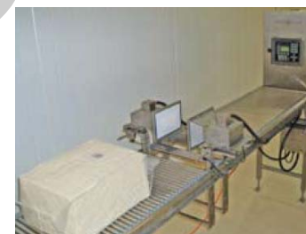
Рис. 4.21. Измерение влажности движущихся образцов влагомером MoistScan
