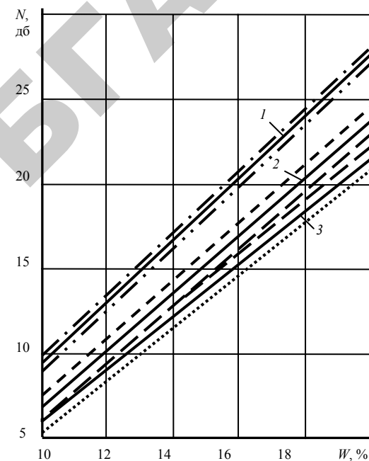
Рис. 2.28. Зависимость ослабления СВЧ-энергии от влажности зерна, приведенная к одинаковой плотности для t = 20 \pm 2^\circ\text{C} : 1 – пшеница; 2 – рожь; 3 – ячмень
