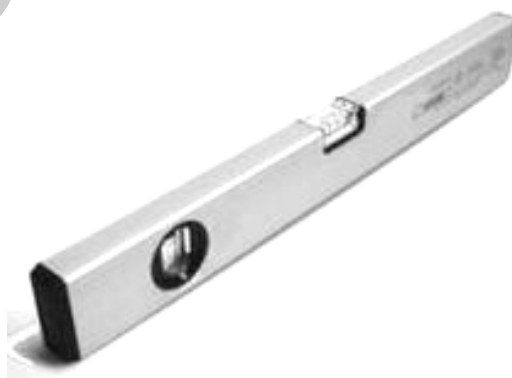
Рис. 2.13. Уровень с двумя ампулами: одна размещена вдоль оси, другая – перпендикулярно
