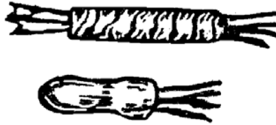
Рис. 3.27. Изолировка места опрессовки
