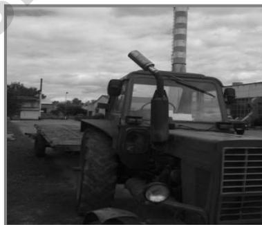
Рисунок 3 – Искрогаситель (выхлопная система МТЗ-80)
