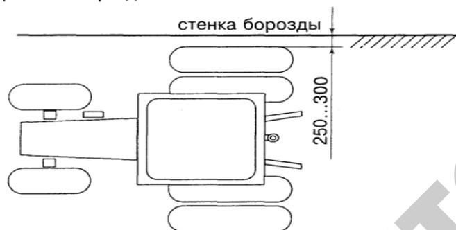
Колея задних колес — в соответствии со схемой сдвигания.
