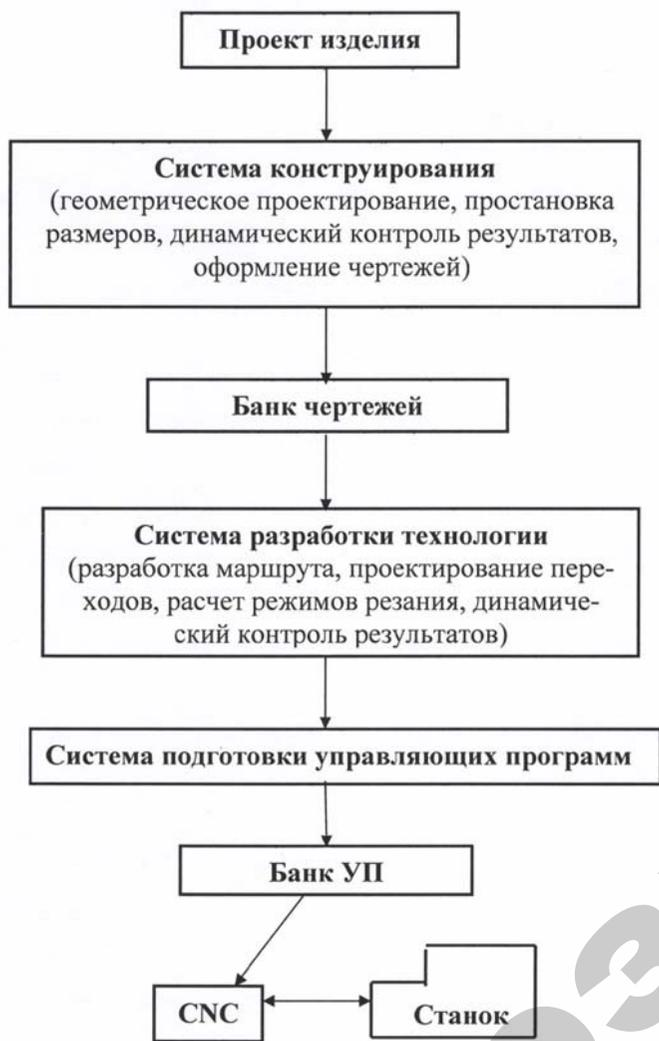
Рисунок 1.2 – Схема структуры интегрированной системы подготовки производства
